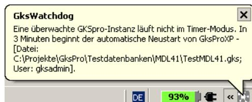
GKS-Watchdog prüft für bis zu neun GKSpro-Instanzen, ob diese – auf dem lokalen Computer unter dem gleichen Benutzerkonto wie GKS-Watchdog – im Automatik-Modus ausgeführt werden. Ist das für eine Instanz nicht der Fall, wird sie nach einer festgelegten Toleranzzeit durch GKS-Watchdog gestartet. Wenn die zu startende GKSpro-Instanz geöffnet ist, aber nicht im Timer-Modus läuft, wird sie zunächst beendet.
